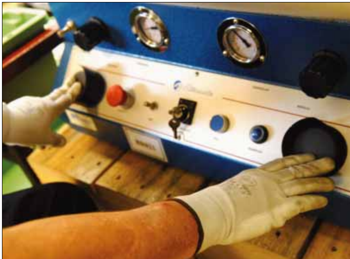
Le choix s'est porté sur une presse hydro-pneumatique de 21 tonnes équipée d'une commande à deux mains de sécurité
