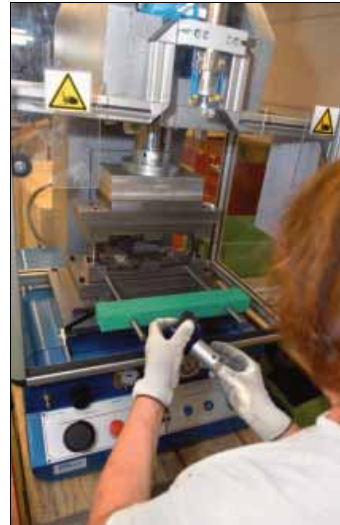
Une presse hydro-pneum. nécessite moins d'entretien qu'une presse excentrique
