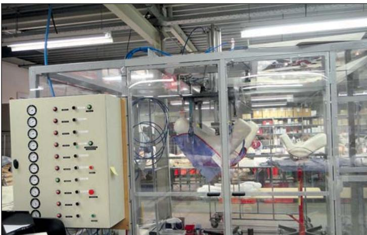
Par souci de sécurité pour le soignant et l'utilisateur, chaque harnais est soumis à des tests rigoureux avant sa livraison. Une inspection visuelle initiale est suivie d'un test sous charge. Il est ensuite soumis à une inspection visuelle finale. Les protocoles des tests de chaque harnais sont conservés.
