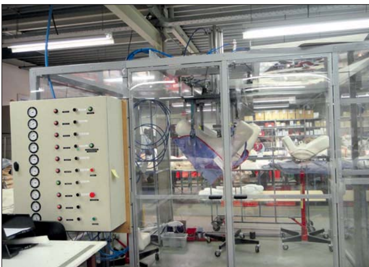
Voor het uitvoeren van de testen heeft de operator een bedieningspaneel met 8 knoppen voor de keuze van het gewicht, een startknop en een resetknop.
