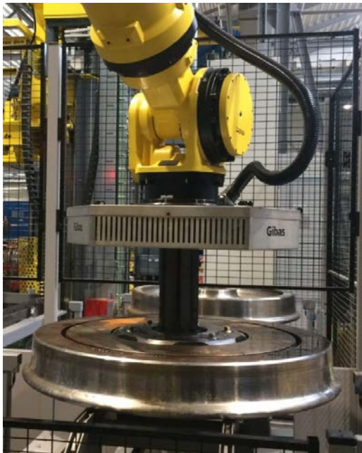
Voor specifieke vereisten (zoals hier: grote variatie in slag, grote gewichten, meefunctie, laag eigengewicht...) is de ontwikkeling van speciale grippers op maat noodzakelijk
