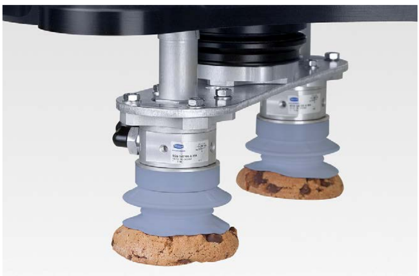
Grippers voor manipulatie van (rauwe) voeding vereist specifieke goedkeuring voor contact met voedsel
