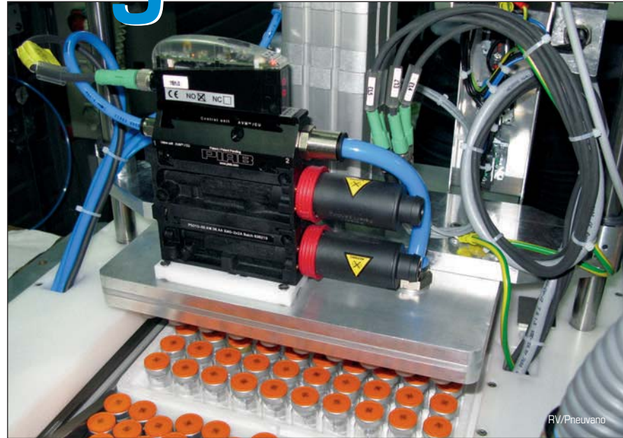
Baxter ontwikkelde een semiautomatische afzetpost die elke flacon door middel van vacuüm opneemt, uit de verpakking heft en op de transportband zet.
