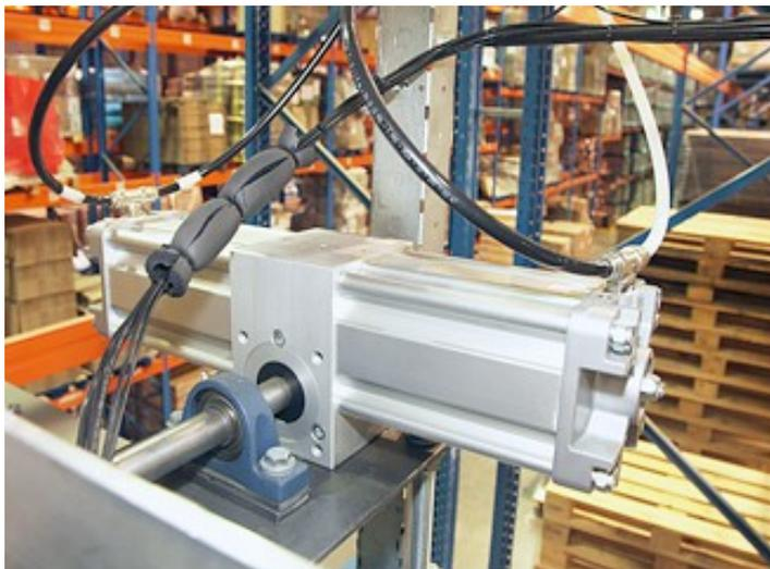
Le culbuteur est entraîné par un vérin tournant pneumatique
